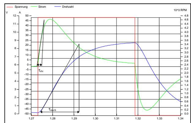
Abb. 3: Elektrische und mechanische Zeitkonstante der elektrischen Gleichstrom-Maschine
