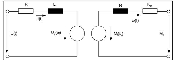
Abb. 1: Elektromechanisches Ersatzschaltbild
