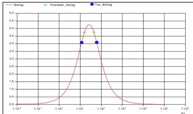
Abb. 4: Darstellung des Betragsfrequenzgangs einer Gleichstrom-Maschine
