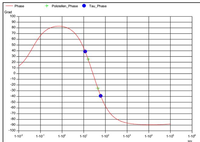
Abb. 5: Darstellung des Phasenfrequenzgangs einer Gleichstrom-Maschine
