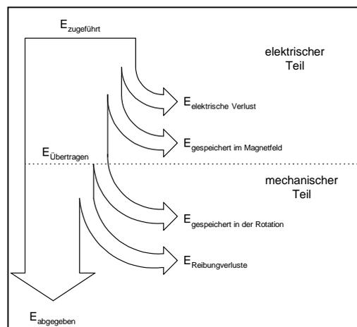
Abb. 2 : Schema der Energieverteilung
