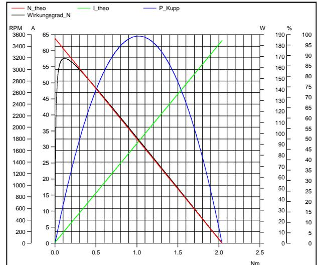
Abb. 6: Kennlinie einer Gleichstrom-Maschine
