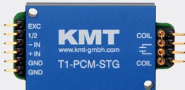
**Miniatur-1-Kanal-Telemetrie für Anwendungen an rotierenden Wellen.**
