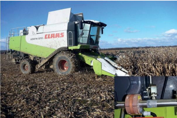
Drehmomentmessung an Mähdrescher
