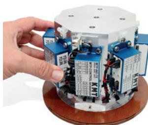
Telemetrie für Bahn-Radsatz-Prüfstand
