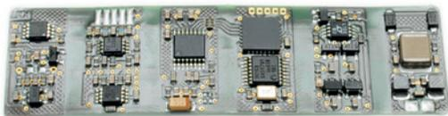
Flexible und biegsame 1-Kanal-Telemetrie für DMS-Messungen bei beengtem Bauraum.
