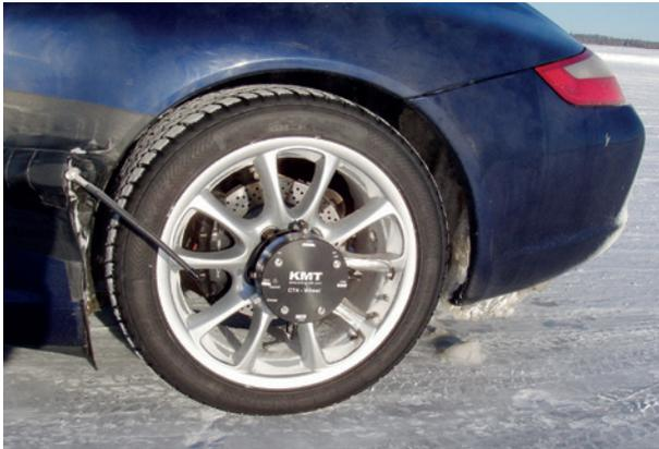
Kraftmessung am KFZ-Rad mit CTP-Rotate
