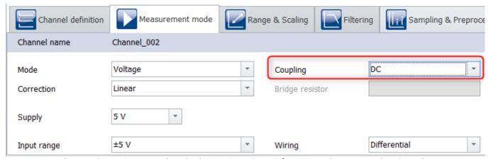
Erkannter ICP-Erweiterungsstecker, aber keine weiteren Sensorinformationen: Spannungsmodus DC-Kopplung
