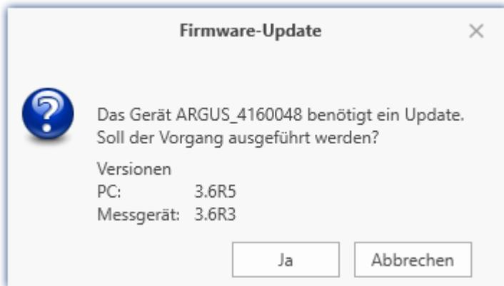
Mit "Ja" startet das Firmware-Update. Die Dauer des Updates hängt von der Anzahl der Verstärker ab (kann mehrere Minuten dauern). Sie werden über den Fortschritt informiert.
