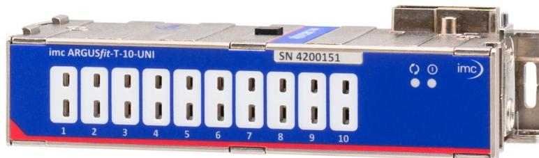
Das T-10 Modul aus der imc ARGUSfit Serie ist ein 10-kanaliger Messverstärker, der Temperaturen mit Thermoelementen aller gebräuchlichen Typen erfassen kann. Er wird in Verbindung mit einem imc ARGUS System (bzw. einer Basiseinheit) eingesetzt, an das er mit seinem Gehäuse direkt angedockt wird.
