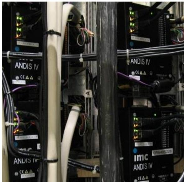
Abbildung 6: Dauerüberwachung mit Messmodulen ANDIS IV der imc Meßsysteme GmbH
