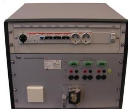
Abb. 1: Prüfplatz mit Anschluss zur Antriebsversorgung und weiteren Messeingängen
