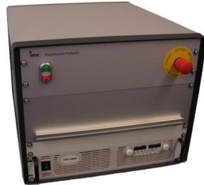
Abb. 1: Prüfplatz mit Spannungsversorgung zur Speisung des Prüflings
