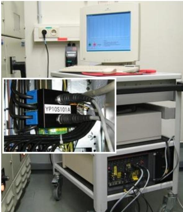
Abbildung 2: Vorortmessung mit festmontierten Stromwandlern an der Armatur Versorgung
