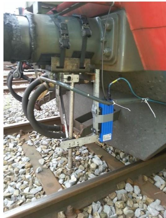
Der LUXACT-Geschwindigkeitssensor wurde an der Zugspitze montiert, damit die Optik nicht mit Seifenwasser verschmutzt wird.
