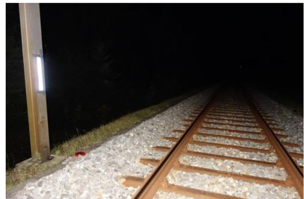
Dank Reflektoren und Lichtschranke kann das Geschwindigkeits-/Wegsignal bei jeder Messfahrt überprüft werden und Fehler wie z.B. einen nicht korrekt ausgerichteter Sensorkopf sofort erkannt werden.
