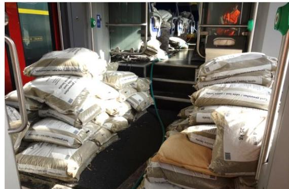
Als Ersatz für das Gewicht der Reisenden wurde der Triebzug mit Sandsäcken beladen. © Foto: SBB
